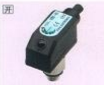
PS20 (电子式压力开关) ● 压力计 0~100, ~300kPa ● 用于气体 ● 开关输出1点 ● 电源 10.8~30VDC ● 外形尺寸 20×20.5×10mm
