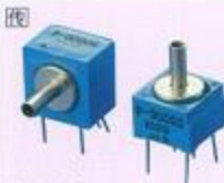
P-3000S ● 压力计·绝对压·压力差 0~490~686 kPa 用于气体 ● 额定输出 100±30mV ● 电源 1.5mADC ● 外形尺寸 17×17×10.5mm
