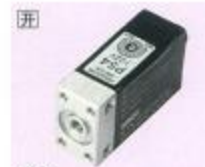
PS4 ● 压力计·压力差 0~98.1, ~981kPa ● 用于气体 ● 开关输出1点, 模拟输出 1~5V ● 电源 12~24VDC ● 外形尺寸 25×45×15.8mm
