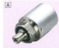
PA-830/838 ● 压力计·绝对压 0~9.8, ~981kPa ● 用于气体·液体 ● 模拟输出 1~5V/4~20mA ● 电源 12~24VDC ● 外形尺寸 φ30×55mm
