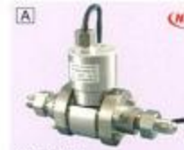
PA-838-D ● 压力计 0~10, 100kPa ● 用于气体·液体 ● 模拟输出 4~20mA ● 电源 24VDC ● 外形尺寸 φ70×40×65.5mm
