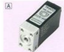
PA-400 ● 压力计 0~98.1, ~981kPa ● 用于气体 ● 模拟输出 1~5V ● 电源 12~24VDC ● 外形尺寸 25×45×15.8mm
