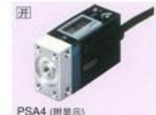
PSA4 (附显示) ● 压力计 0~100, ~1000kPa ● 用于气体 ● 2 2/1 位数码显示 ● 开关输出1点, 模拟输出 1~5V ● 电源 12~24VDC ● 外形尺寸 25×45×15.8mm
