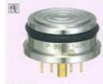
P-8505 ● 压力计 0~50, ~1000kPa ● 用于气体·液体 ● 额定输出 90±30mV ● 电源 1.5mADC ● 外形尺寸 φ20×16.5mm
