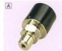
PA-500 ● 压力计 0~98.1, ~981kPa ● 用于气体·液体 ● 模拟输出 1~5V ● 电源 12~24VDC ● 外形尺寸 φ28×52.2mm
