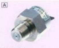
PA-860/868 ● 压力计 0~5, ~35MPa ● 用于气体·液体·油压 ● 模拟输出 1~5V/4~20mA ● 电源 12~24VDC ● 外形尺寸 φ30×41mm
