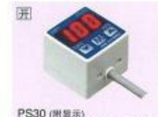
PS30 (附显示) ● 复合压 -100~100, ~1000kPa ● 用于气体 ● 2 1/2 位数码显示 ● 开关输出2点 ● 电源 12~24VDC ● 外形尺寸 □31×25mm
