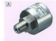
PA-850/858 ● 复合压·绝对压 -100~300, ~1000kPa ● 用于气体·液体 ● 模拟输出 1~5V/4~20mA ● 电源 10.8~30VDC ● 外形尺寸 φ35.2×48.5mm
