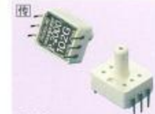
P-2000 ● 压力计 0~9.81, ~981kPa ● 用于气体 ● 额定输出 90±40mV ● 电源 1.5mADC ● 外形尺寸 10×12×5.2mm
