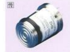
P-5100 ● 压力计 0~9.81, ~981kPa ● 用于气体·液体 ● 额定输出 100±50mV ● 电源 1.5mADC ● 外形尺寸 φ20×23mm
