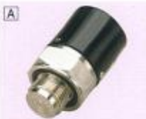
PA-800 ● 压力计 0~98.1, ~981kPa ● 用于气体·液体 ● 模拟输出 1~5V ● 电源 12~24VDC ● 外形尺寸 φ28×50.2mm
