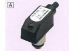
PA-20 ● 压力计 0~100, ~300kPa ● 用于气体 ● 额定电压 1~5VDC ● 电源 10.8~30VDC ● 外形尺寸 20×20.5×10mm
