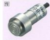
P-8600 ● 压力计 0~5, ~35MPa ● 用于气体·液体 ● 额定输出 40±5mV ● 电源 5VDC ● 外形尺寸 φ12.7×25.5mm
