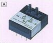
PA-100 ● 压力计·压力差 0~1, ~5 kPa ● 用于气体·液体 ● 额定电压 0.5~4.5V ● 电源 5VDC ● 外形尺寸 22.5×25×10.5mm
