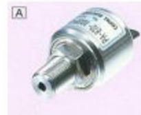
PA-870/878 ● 压力计 0~2, ~5MPa ● 用于气体·液体 ● 模拟输出 1~5V/4~20mA ● 电源 12~24VDC ● 外形尺寸 φ30×26mm
