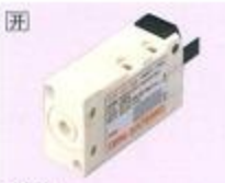
PS40 ● 压力计 0~100, ~1000kPa ● 用于气体 ● 开关输出1~2点, 模拟输出 1~5V ● 电源 10.8~30VDC ● 外形尺寸 24.8×45×15mm
