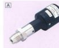
PA-930 (对应高温) ● 压力计 -100~100, 0~1000 kPa ● 用于气体·液体 ● 模拟输出 1~5V ● 电源 12~24VDC ● 外形尺寸 φ30×91.5mm
